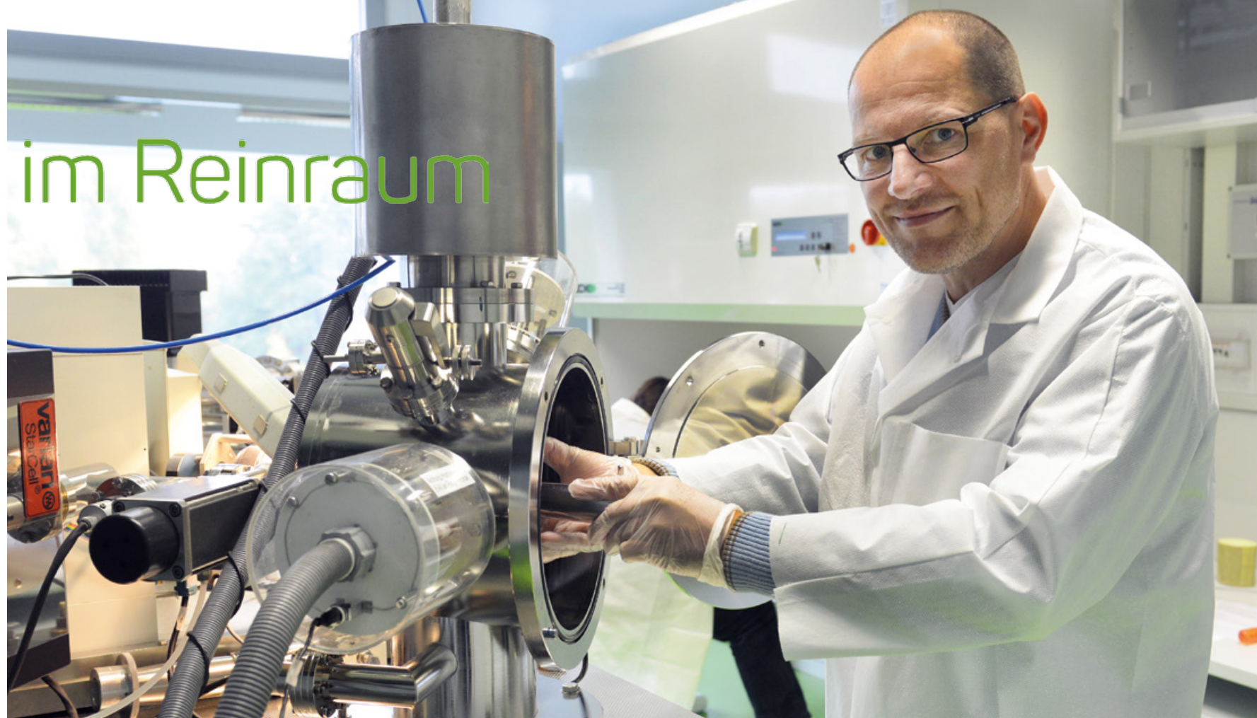
Jochen Vogl wechselt am Thermionen-Massenspektrometer das Probenkarussell
